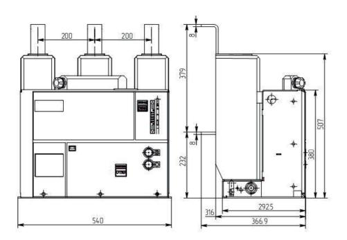
Вакуумный выключатель ВВТЭ-М-Р-10-20/630A УХЛ2, 100B,  $50\Gamma$ ц (028-09)
